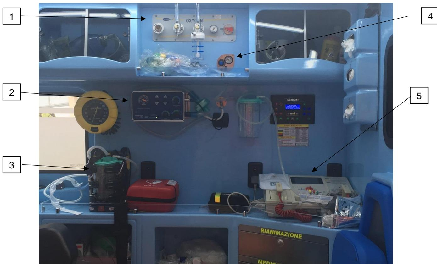
1. Barra erogazione gas medica completa di N.3 prese erogazione ossigeno (UNI 9507) con innesto rapido, N. 1 scambiatore manuale, N. 1 manometro per la visualizzazione della quantità di gas presente all'interno della bombola selezionata.
