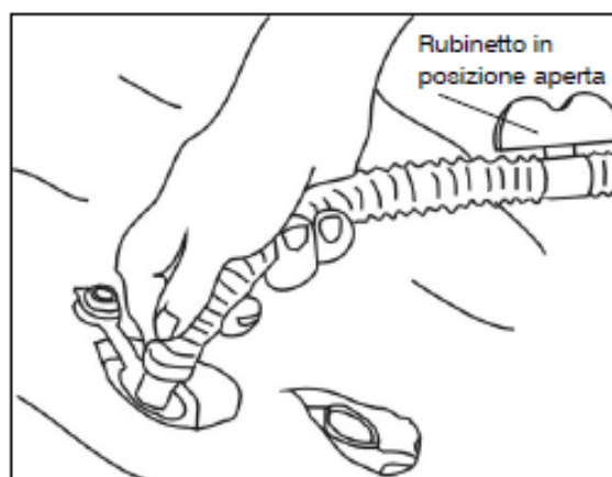
Figura 2.10 – Innesto a pressione della tubazione alla valvola di gonfiaggio.
